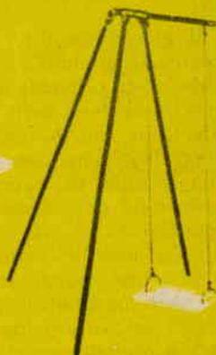
Il telaio per l'altalena richiede due raccordi diritti per le gambe, in combinazione con uno snodo regolabile che regge i rinforzi diagonali. Le due metà dello snodo sono unite assieme al tubo corto.
